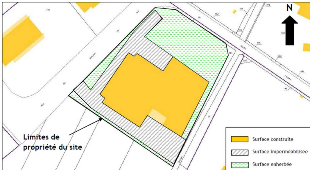
Figure 5 : Présentation des surfaces imperméables et des zones enherbées présentes sur le site
