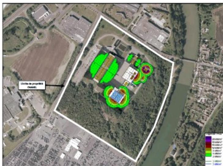
Figure 15 : Résultats de la modélisation des flux thermiques émanant des locaux du site CHANEL dans le cas d'incendies
